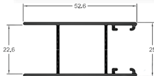
SK068 / SU068 Peso: 0,539 kg/m Montante Lateral VZ Janelas
